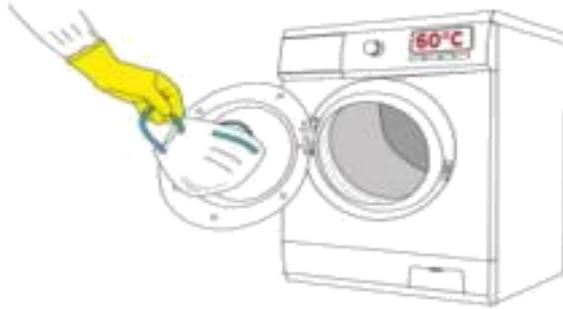
**Figure 5 — Méthode de lavage d'un masque barrière** (Source : AFNOR SPEC S76-001)
