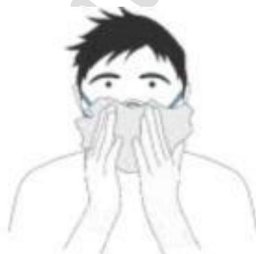
**Figure 7 — Essai d'étanchéité d'un masque barrière (Source : AFNOR SPEC S76-001)**
